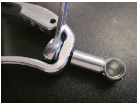
Die Kugelpfannen in die Querlenker stecken und mit den Muttern M6 (12/133) festschrauben.
