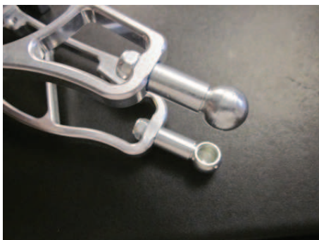
Die Öffnungen der Kugelpfannen am oberen Querlenker müssen unten sein, bei den unteren Kugelpfannen muss die Öffnung oben sein.
