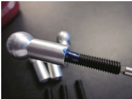
Die Madenschrauben in die Kugelpfannen schrauben.
